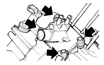
Tightening torque: 9÷11 Nm
